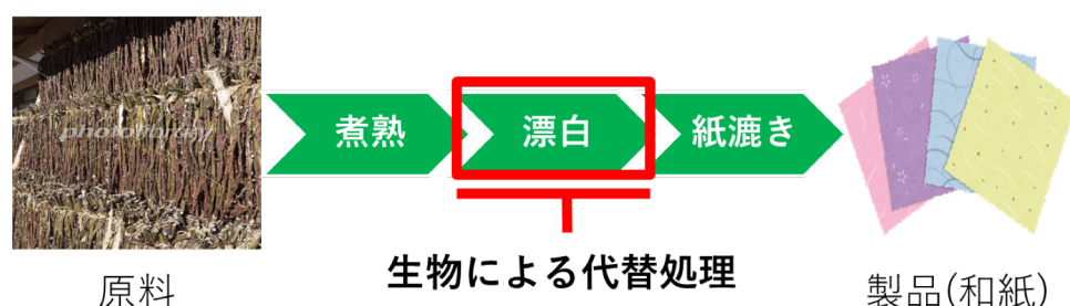
図 2-1. 和紙における製紙過程の概略図. 多くの複雑な過程を必要とするため大規模工場での生物処理の利用は難しい. 一方, 小規模・単純な工程で製造される和紙などは生物処理に置き換えられる.
