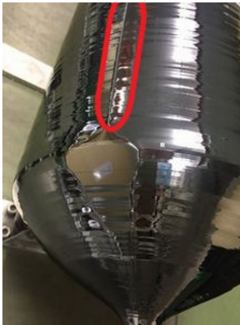
図 1.2 シリコン表面に出現した晶癖線
