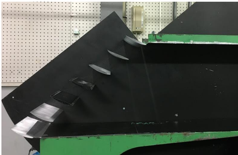
図 17 直線翼列風洞測定部
