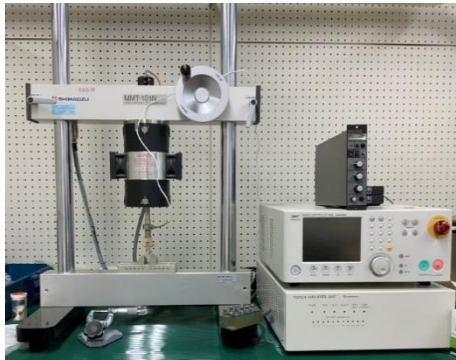
図 3-3 3点曲げ試験機 (SHIMAZU, MMT-101N)
