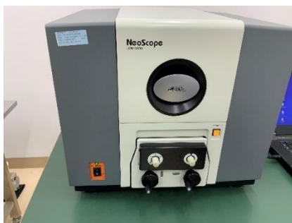
図 3-10 走査型電子顕微鏡 (JEOL, JCM-5000)
