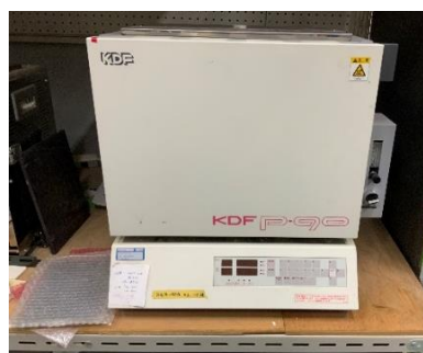
図 2-4 マッフル電気炉 (KDF P90G)
