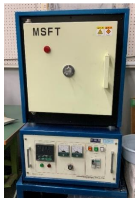
図 2-7 高温電気炉 (YAMADA DENKI MSFT-1020)
