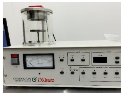
図 3-11 スパッタ装置 (CRESSINGTON, Sputter Coater 108auto)
