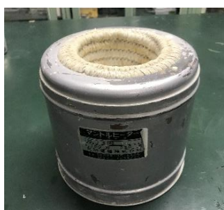
図 2-3 マントルヒーター(大化電器, GB-5)
