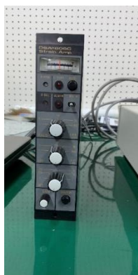
図 3-8 DSA-605C Strain-Amp
