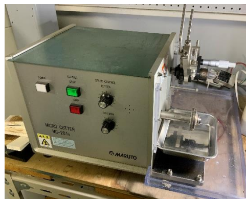
図 2-10 ダイヤモンドカッター (MARUTO, Micro cutter MC-201N)
