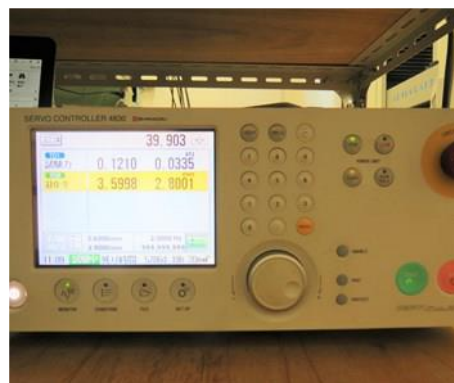
Figure. 3.7 : 油圧サーボ式疲労試験機および制御機
