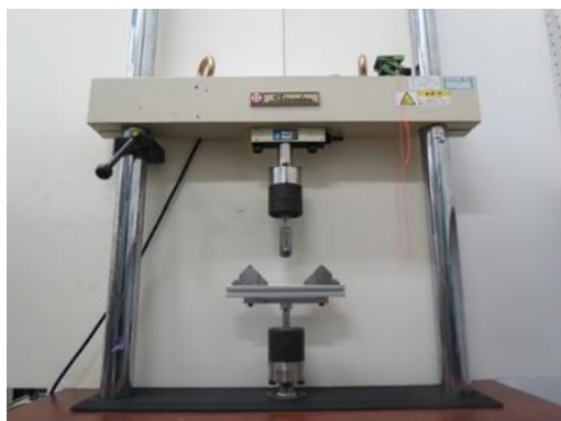
Figure. 3.7 : 油圧サーボ式疲労試験機および制御機
