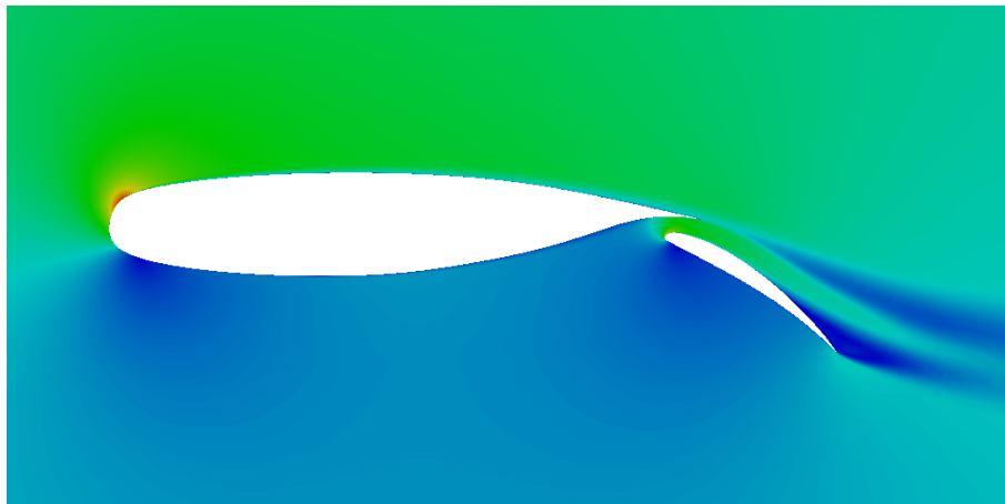
Mach number 0.000017 0.172 0.345 0.517 0.689700 図 3.7 0~50%位置を移動壁としたときのマッハ数分布
