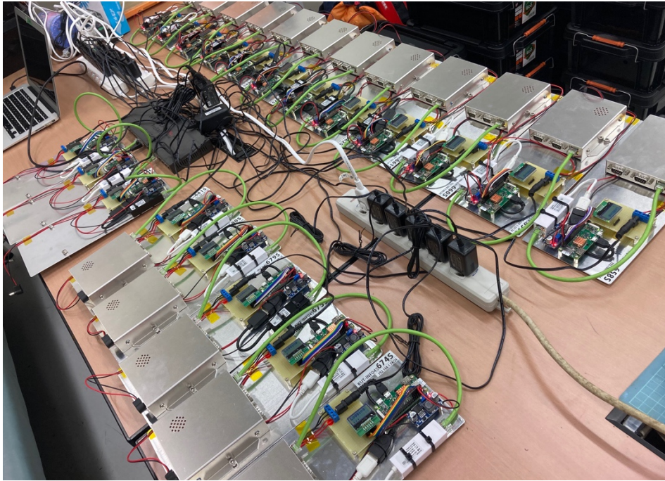
図 2.27 ロガー動作試験の様子
