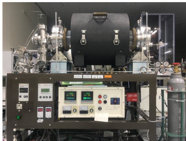
図5 本研究で使用したアニーリング装置
