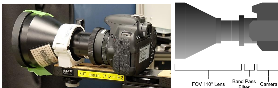
図 2.6 カメラとその構成概略図。視野角(FOV)110度の像側テレセントリックレンズの像側にBPFを取り付け、EFマウントリングを介してCanon EOS Kiss X9iに取り付けている。BPFとレンズの接続はねじ込み式になっており、このねじ込み量でフォーカス調整を行い、固定リングでフォーカスの固定を行う。
