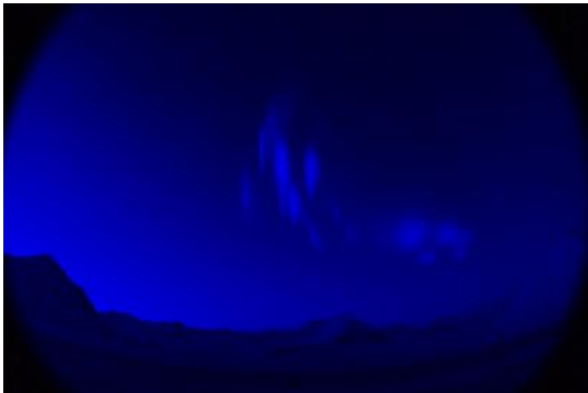
図 2.2 C-REX-1 の観測画像例(Ny-Ålesund)。幅 12 nm の BPF(Ba + 用: 455.4 nm)を用いたもの。画像中心部に縦に伸びる Ba + 、その右下に球状の Sr が見られる。
