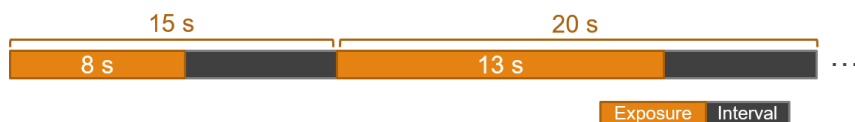
図 3.5 撮影のサイクル。15 秒と 20 秒が交互に経過するごとに、それぞれ 8 秒と 13 秒の露光(Exposure)を行うサイクルを繰り返す。
