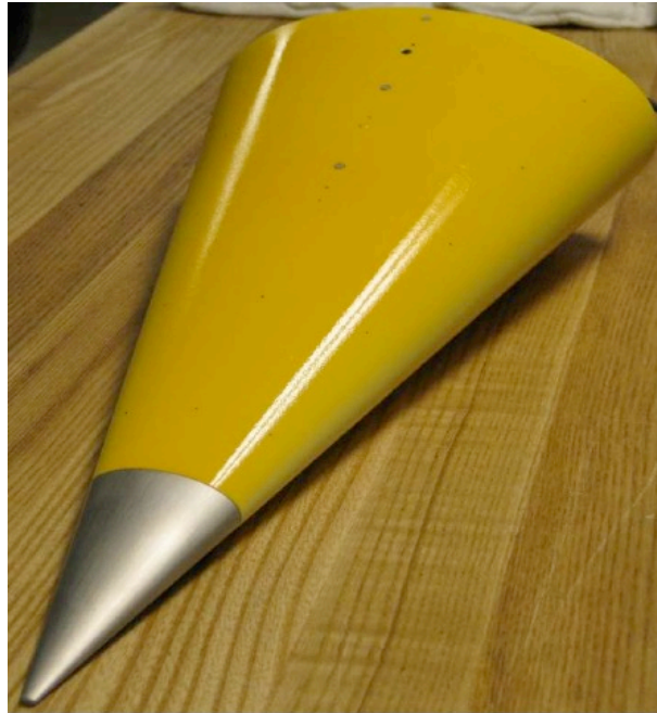
図 1.3 HIFiRE-5 の楕円錐模型 [12]
