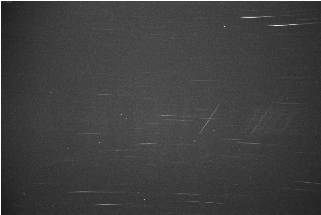
図 3.8 183_4 流星は画面下から上に向かって流れた。画面中央右側に 0 次光が見られ、右側に淡い流星スペクトルの輝線が確認できる。明るい輝線は 2 本で左から Mg I (518.2 nm)、O I (777.4 nm) であると考えられる。
