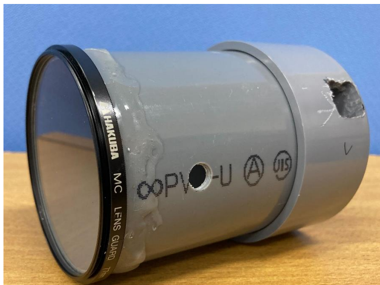
図 2.6 自作したカメラハウジング。隙間部分に水滴が入り込まないようにビニール袋で覆い使用した。
