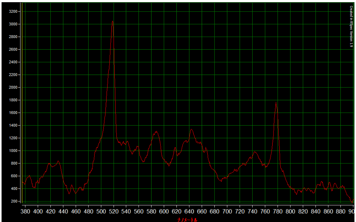
図 3.14 183_5 波長校正結果 波長校正結果 Na I (589.2 nm) のピークが 588.3 nm となっており誤差 0.9 nm 程度で波長校正されている。
