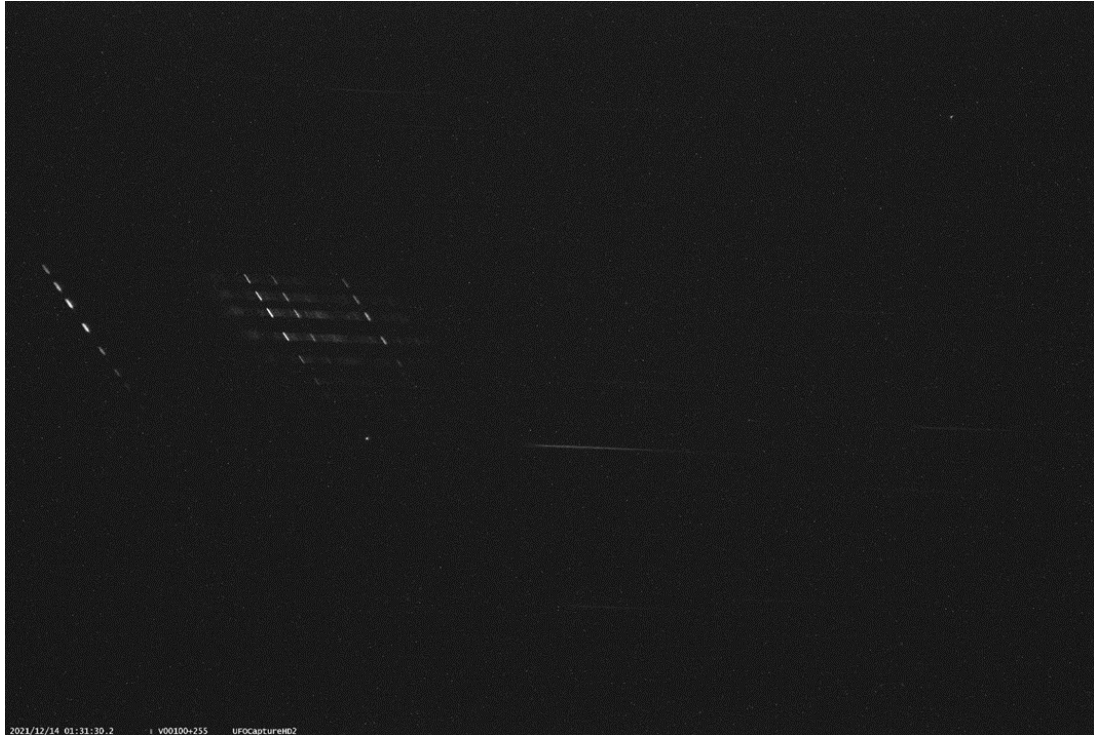
図 3.3 178_2 流星は画面下から上に向かって流れた。画像左端に 0 次光が見られその右側に 1 次の輝線スペクトルが確認できる。明るい輝線が 3 本確認でき左から Mg I (518.2 nm)、Na I (589.1 nm)、O I (777.4 nm) であると考えられる。
