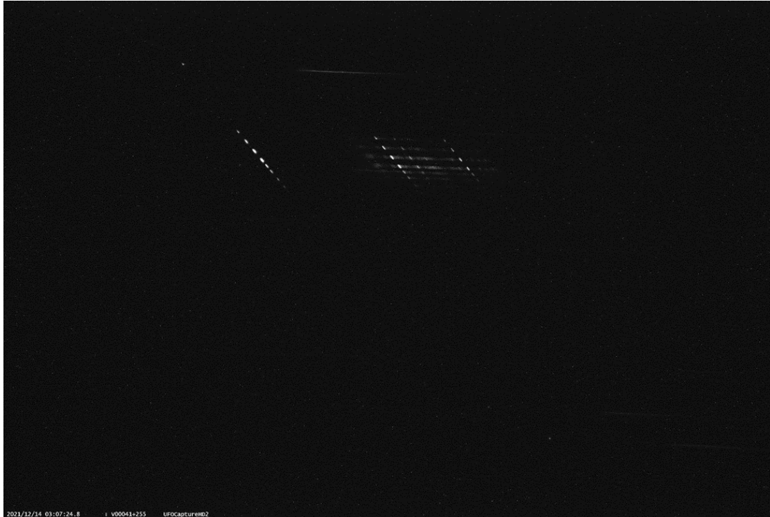
図 3.5 178_3 流星は画面下から上に向かって流れた。画面中央左側に 0 次光が見られ、右側に流星スペクトルの輝線が確認できる。特に明るい輝線は 3 本確認でき左から Mg I (518.2 nm)、Na I (589.1 nm)、O I (777.4 nm) であると考えられる。
