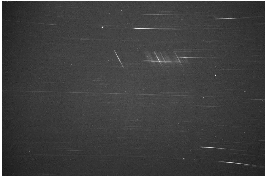
図 3.6 183_3 流星は画面下から上に向かって流れた。画面中央左側に 0 次光が見られ、右側に流星スペクトルの輝線が確認できる。露光時間が長いことにより流星スペクトルに重なって恒星の連続スペクトルが記録されている。解析するとき恒星光スペクトルの重なっていない部分を使用するように注意が必要である。
