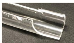
図 3.2: 固定治具が壊れた様子
