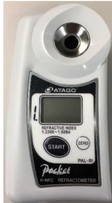
図 4.1.2:使用した株式会社アタゴ ポケット濃度・屈折計 PAL-RI
