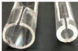
図 3.4: 図 3.1 で使用したアクリルパイプ(左側)と図 3.3 で使用したアクリルパイプの実際の断面
