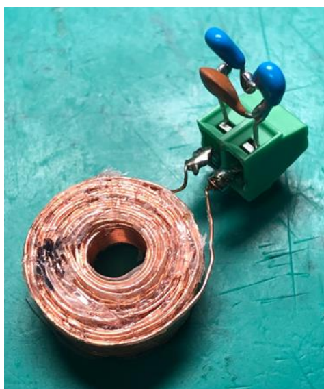
図 43. 共振周波数(70 kHz)のために積層コイルに接続したキャパシタ
