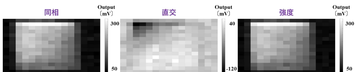
図 48. 積層コイルの回路で共振周波数を調整した際の磁界分布
