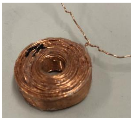
図 38. 磁界の吸収に用いた積層コイル(約 200 回巻, 平均直径 = 0.8 cm)
