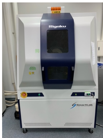
図 5. 本研究で使用した XRD (Rigaku Smart Lab(9kW))
