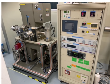
図2. 本研究で使用した RF マグネトロンスパッタリング装置(ANELVA E-200S)
