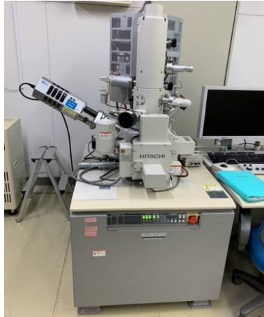
図 4. 本研究で使用した FE-SEM (HITACHI SU-8020)
