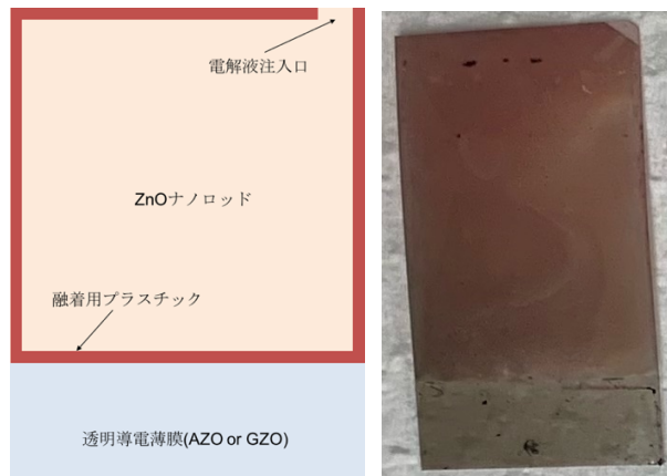
図 26. 色素吸着後の ZnO ナノロッド電極（左：イメージ図、右：実物）
