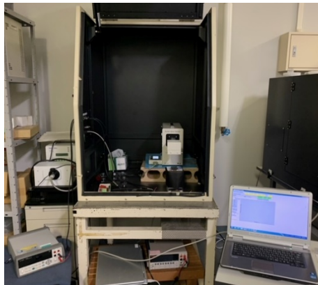
図 8. I-V 測定のシステム(ソーラーシミュレータ : Peccell PEC-L01)
