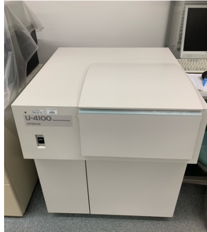
図 7. 本研究で使用した分光光度計 (HITACHI U-4100)
