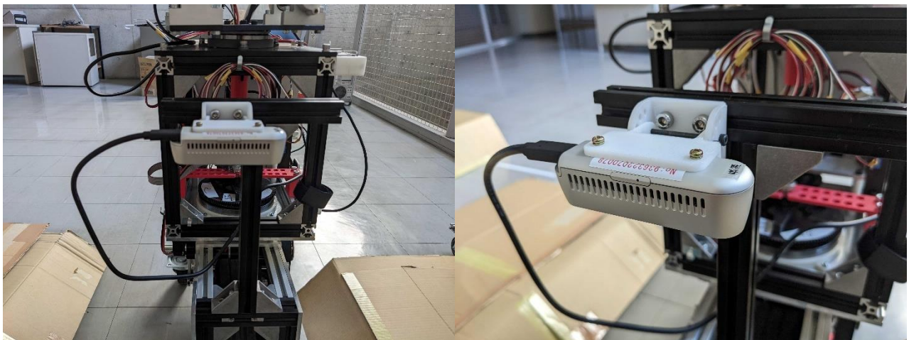
Fig.5.7 試験機に取り付けた RGB+深度カメラ
