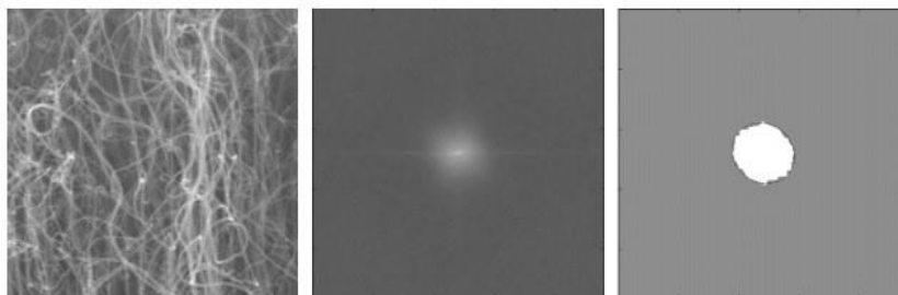
図 1.4 低配向 CNT の SEM 画像、パワースペクトル、半値強度の楕円近似[6]
