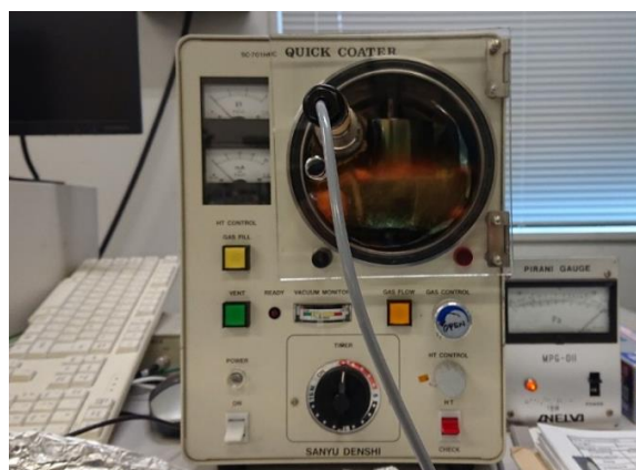
図 2.10 簡易スパッタ装置 (SANYU ELECTRON SC-701-HMC QUICKCOATER)
