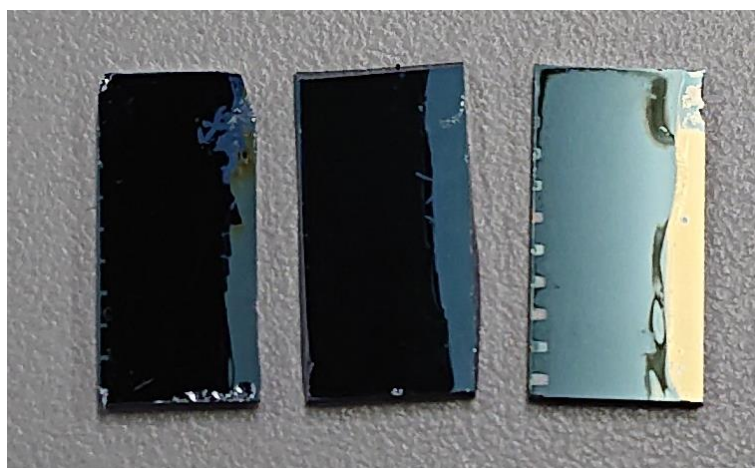
図 5.5 各触媒マスク条件のパターン CNT フォレスト基板 (左：アルミナ 30nm、中央：アルミナ 15 nm マスク、右：金)
