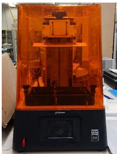
図 2.1 3D プリンター(Phrozen sonic mini 8k)の外観
