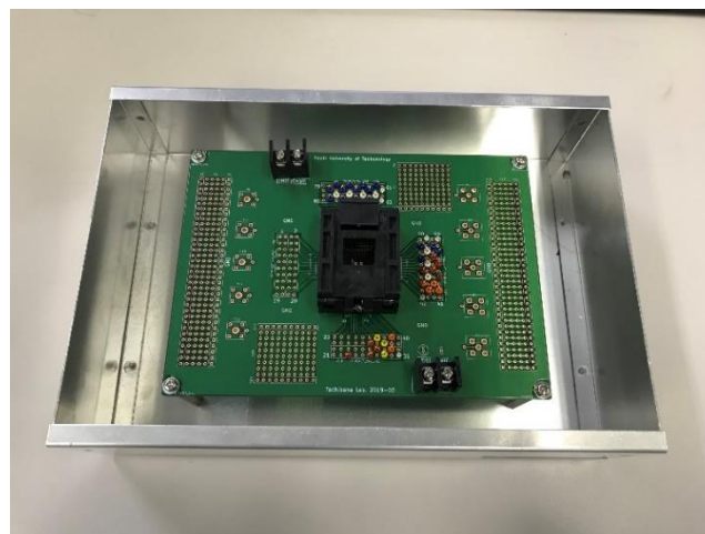
図 5.5 作成した測定用治具
