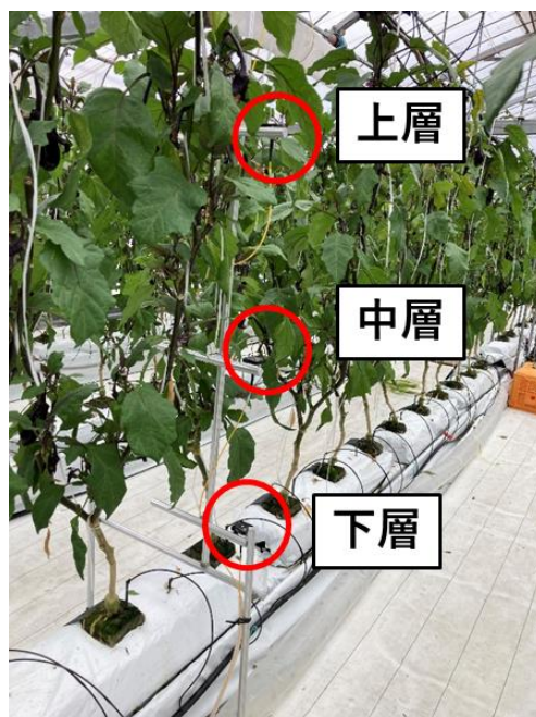
図 27. 透過光を測定するためのコサインコレクタ
