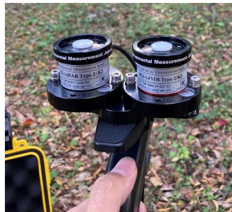
図 4. 市販の LAI 計 日本環境計測株式会社製 LAI-15 LAI/P
