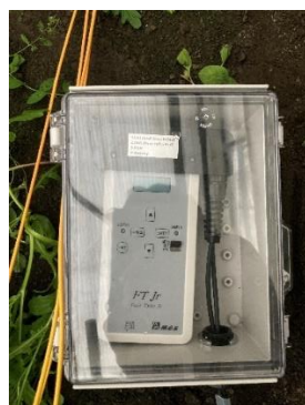
図 37. 防水ボックスに格納したデータロガー
