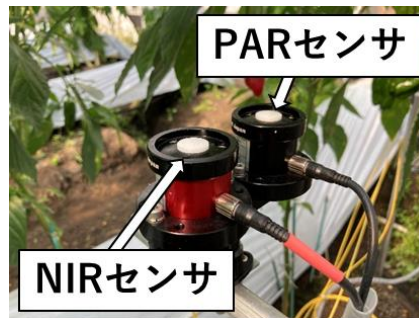
図 14. MIJ-15 LAI/P の PAR センサと NIR センサ
