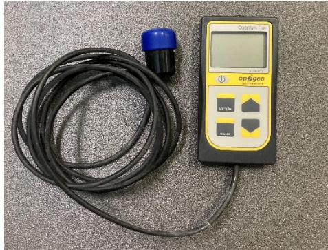
図 2. 市販の PPFD 計 Apogee INSTRUMENTS 製 MQ-200
