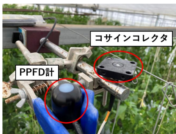
図 26. 骨組みに設置したコサインコレクタと PPFD 計
