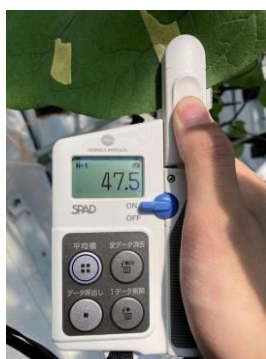
図 34. コニカミノルタ製 SPAD-502Plus による測定
