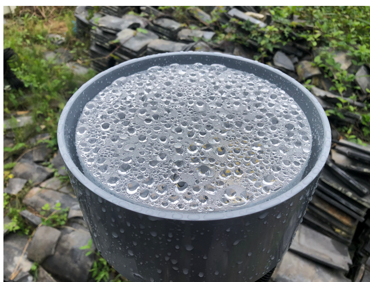
図 5.7: PVC 箱内部が結露した状態
