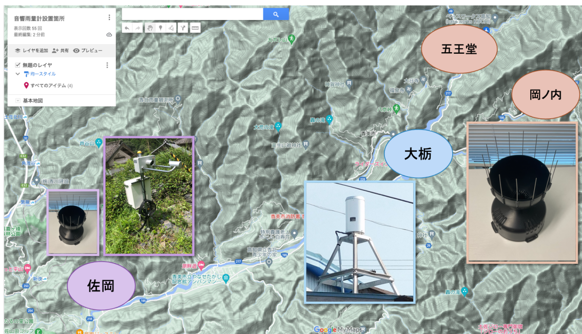
図 1.2: 観測地点 (佐岡: 簡易雨量計・ディストロメータ、大栃: アメダス、五王堂・岡ノ内: 簡易雨量計)
