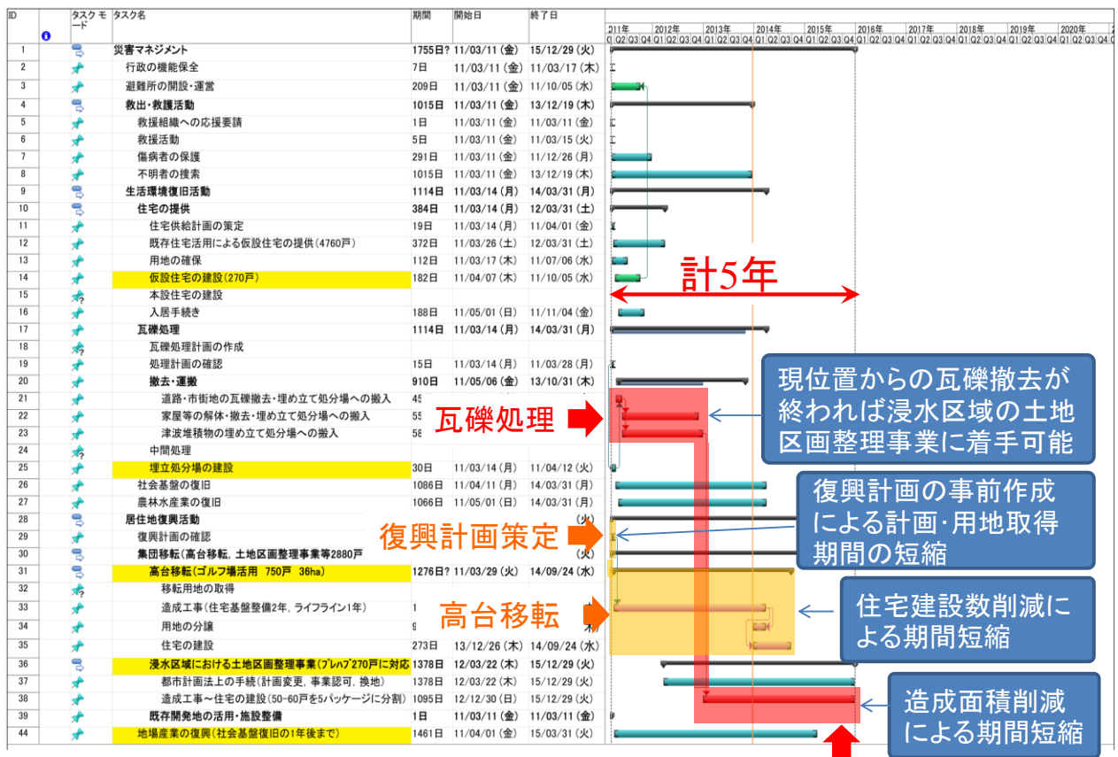
図-5 (B) 復興スケジュール検討のイメージ図：短縮策導入
