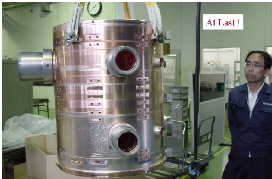
図 3.52: ロウ付け後の空洞。表面の異なる色の光沢は表面に付着したロウ材
