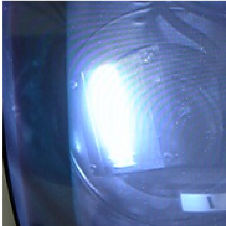
図 3.100: 蛍光板モニタで観測した 5MeV ビーム
