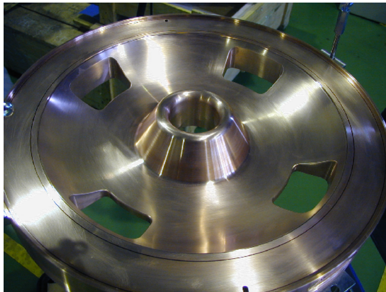
図 3.49: カップリングスロット研磨後の空洞リング
