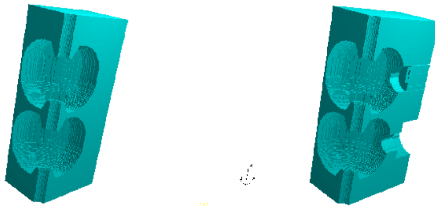
図 3.23: ポートによる周波数ずれ検討: 計算は1/4モデルで行ったので、周波数のずれは計算値の半分である
