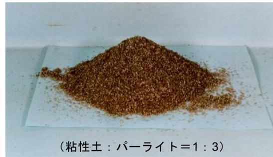
写真 6.5 高含水の粘性土とパーライト混合処理後の粘性土
