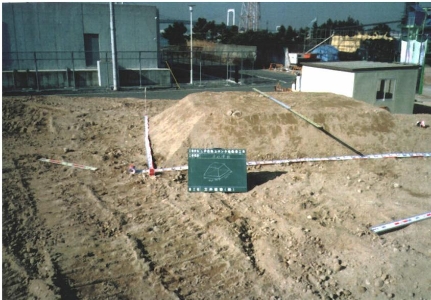
写真 6.3 プラントで混合試験した混合土の体積測量
