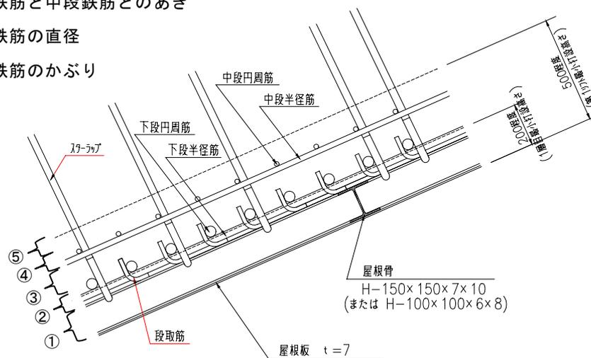
図 5.17 コンクリート製屋根第1リフトの配筋状況
