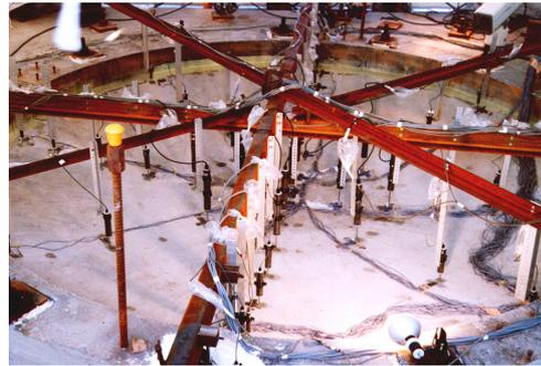
写真 4.3 変位計の取り付け状況
