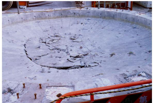
写真 4.4 破壊状況 (CASE5)
