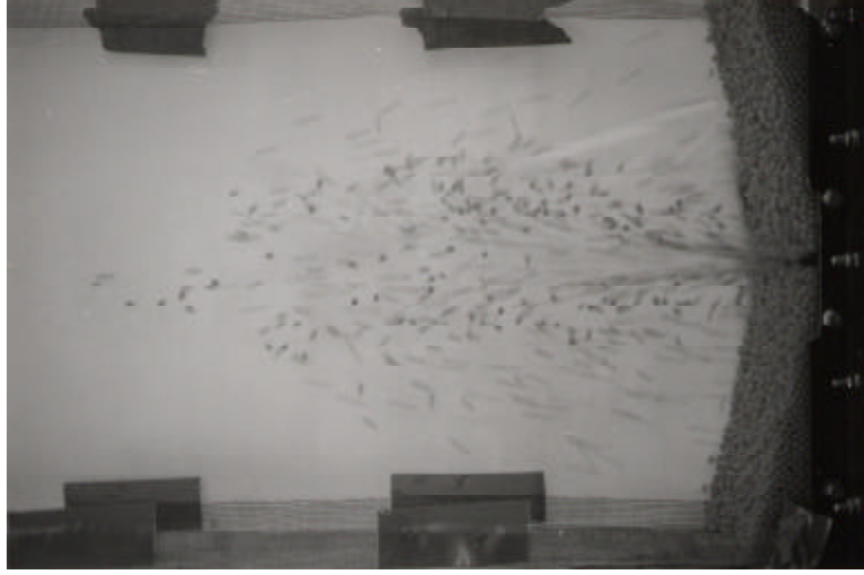
図 5 - 12 投入粒子数と噴流の様子
