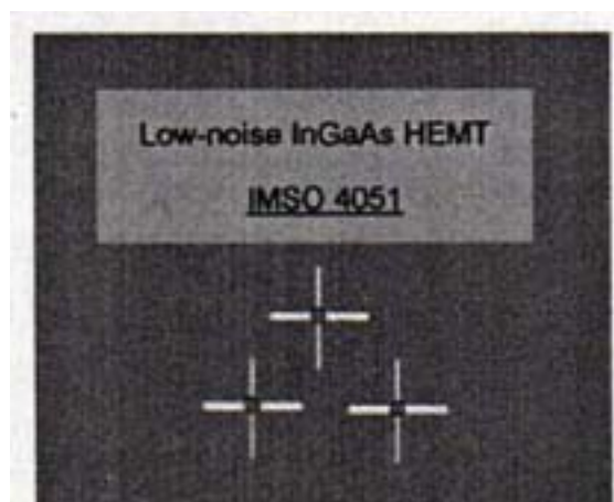
図 3-13 低雑音 P-HEMT のチップ写真 (CHIP SIZE : 0.4mmx0.5mm)
