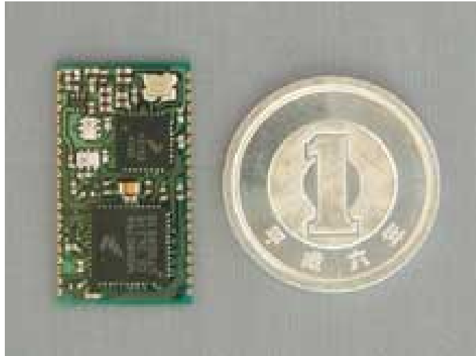
図 5 SiP 技術を用いて超小型化に成功した GPS モジュール(新光電気株式会社)
