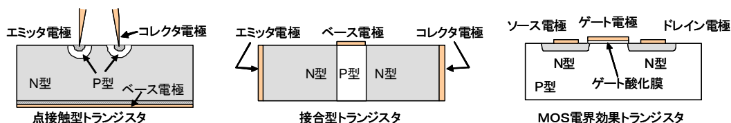
図 5-8 半導体トランジスタの構造模式図
