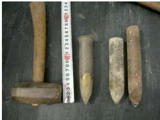
写真-3 「はつり仕上げ」に使用した道具
