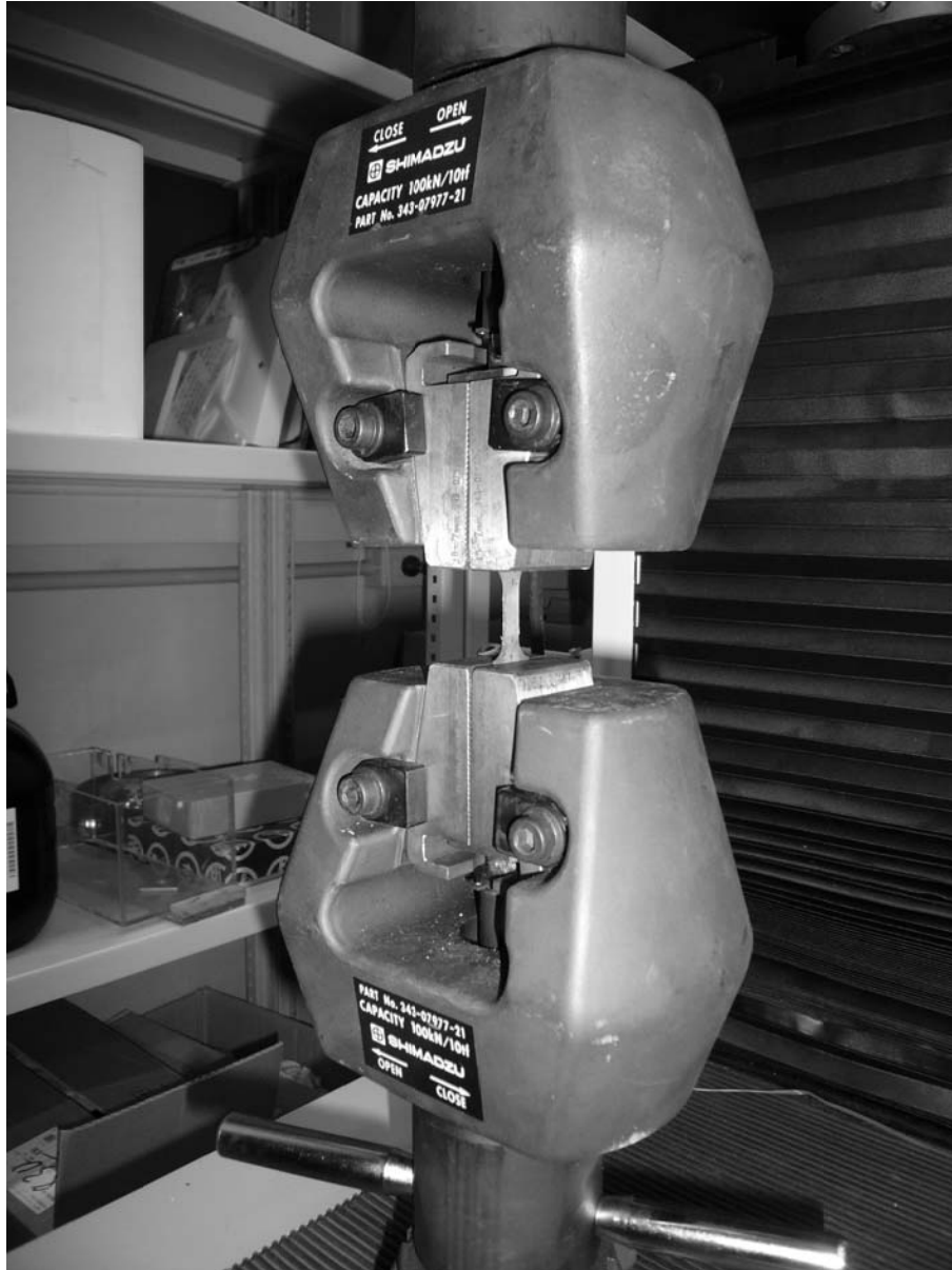
Fig.4-2 Tensile testing machine
