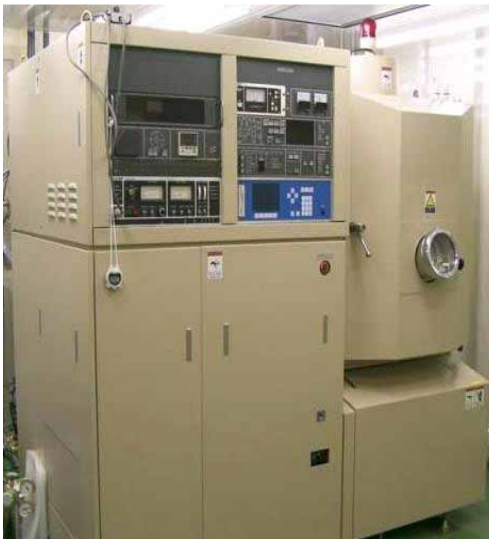
図 20. 電子ビーム蒸着装置 (EB-PVD) 外観：日本真空製 EBX-16C
