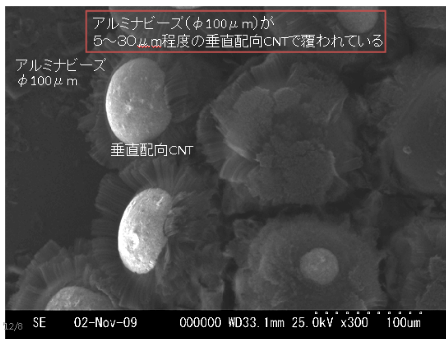
図73. キレート溶液法を用いたアルミナ球へCNT成長
