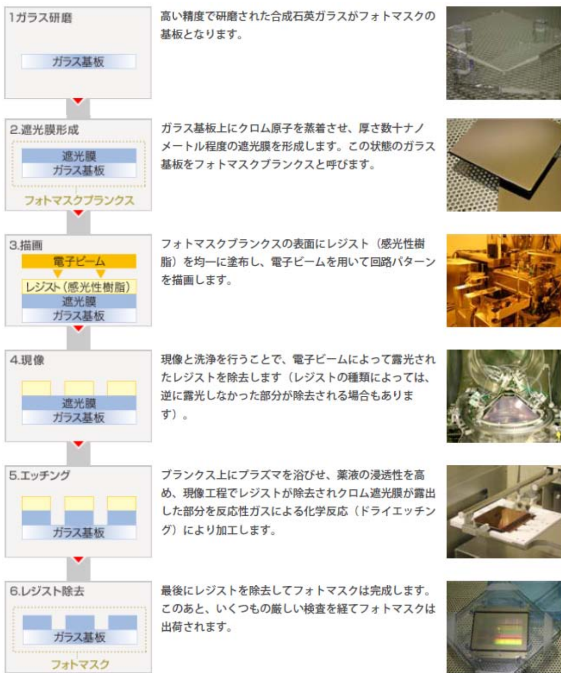
図 19-57 半導体製造用マスクの製造工程
