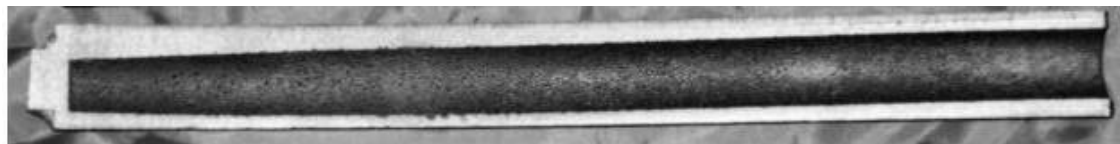
図 2-2-2-11 縦置き方案 低通気度塗型塗布铸造例
