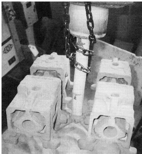
図 2-2-1-9 4個込め方案の型ばらし状況
