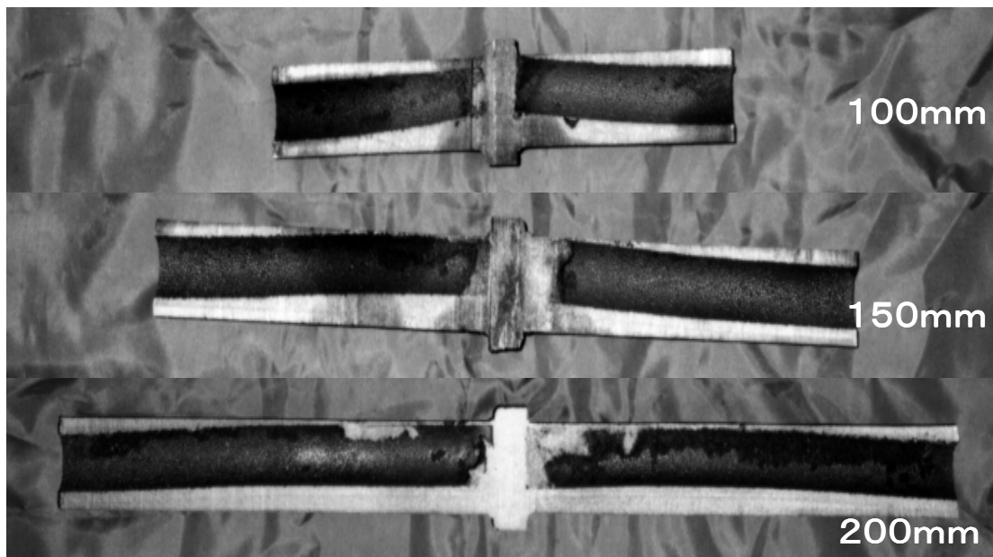
図 2-2-2-6 横置き鋳物切断面
