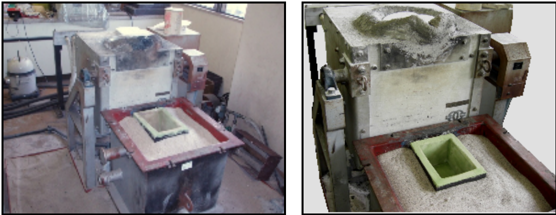
図 4-1-4 実験に用いた高周波誘導炉
