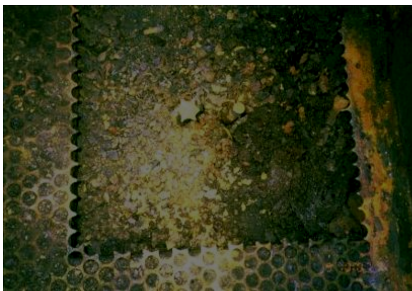
図 2-2-3-4 フラスコ減圧室内の金網に生じた堆積物の外観
