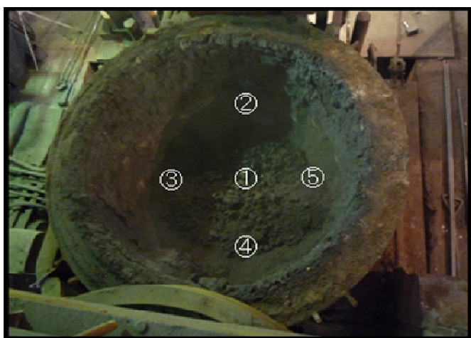
図 4-2-3 温度測定箇所
