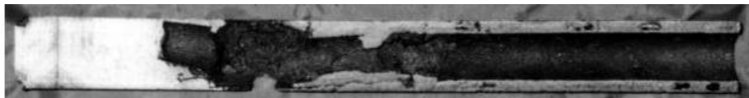
図 2-2-2-8 縦置き鋳物切断面
