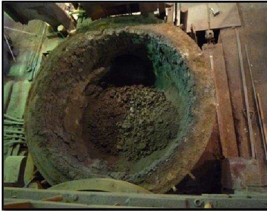
① 炉底に加炭材投入
