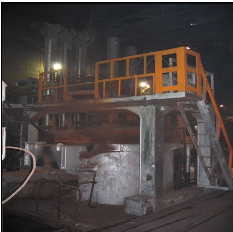
図 4-2-1 実験に用いたアーク式溶解炉
