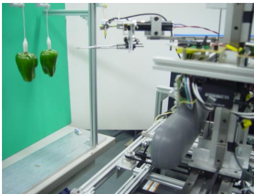
図6-7 カメラを移動させた場合のピーマン認識実験
