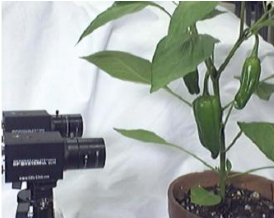
図 2-19 ステレオカメラによるカメラとピーマンの距離計測の実験の様子
