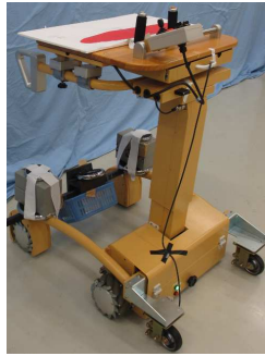
30.8kg荷重-後真ん中 重心位置( d = 0.01\text{m} , \alpha = 90^\circ )
