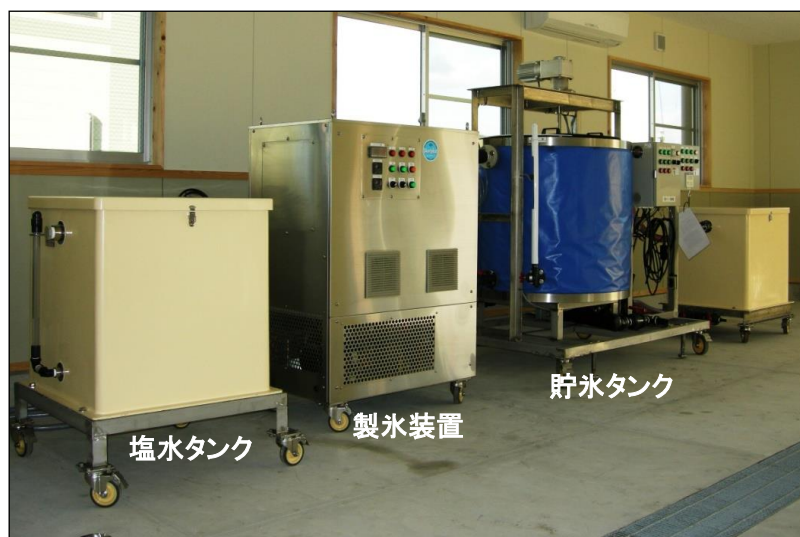
図18 中土佐町に導入されたスラリーアイス製造システム（中土佐町鮮度保持研究施設） （提供：松本泰典・高知工科大学地域連携機構准教授）
