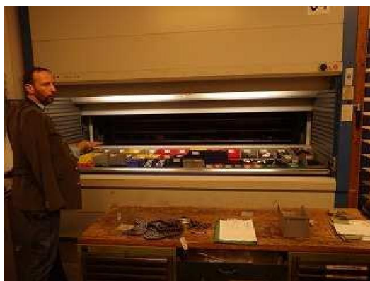
③パーツラック 自動で必要なパーツが入ったラックが選択される
