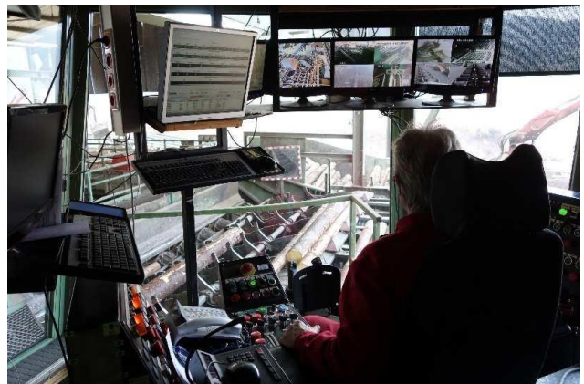
⑦選木機のオペレータ室 コンピュータとモニターで管理
