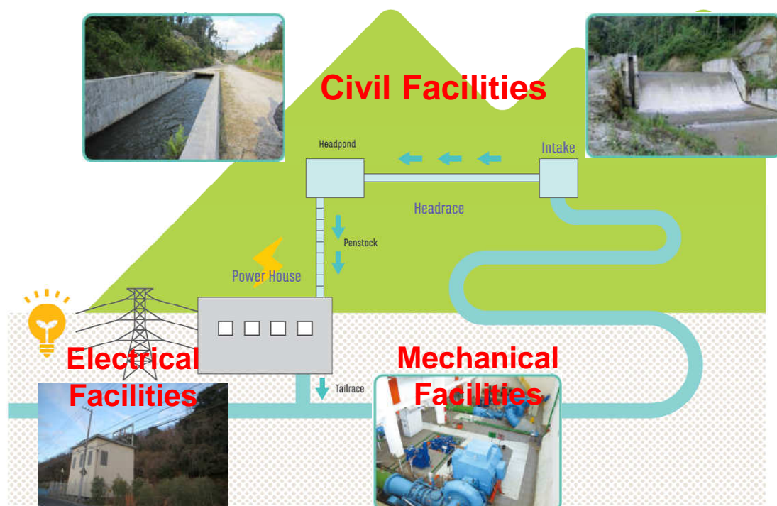
図 5-3 小水力発電所の設備概要
