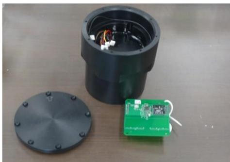
図 20 磁気センサ埋設機器
