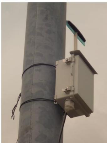
図 22 磁気センサデータ受信親機部分
