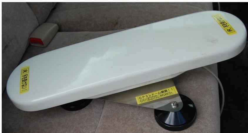
図 42 GPS コンパスの概観
