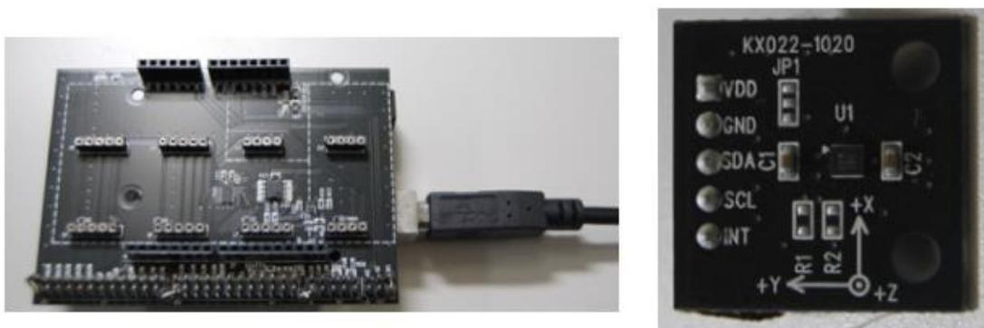
図 84 センサシールド（左）と加速度センサ（右）
