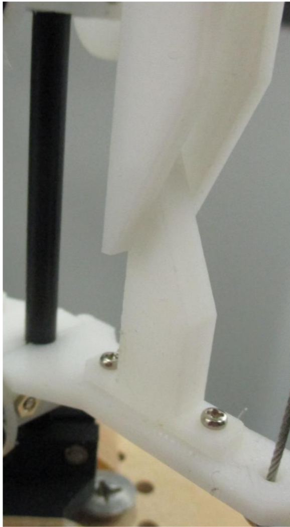
Fig.5-5 試作機のねじれ防止機構
