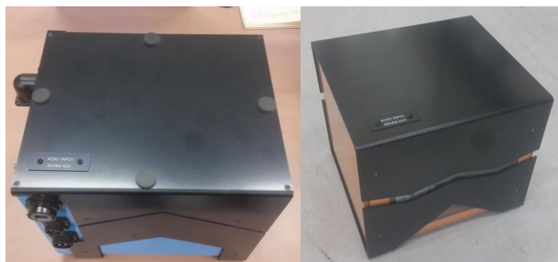
図 2.2 株式会社 SAYA と共同開発した複合型インフラサウンドセンサ
