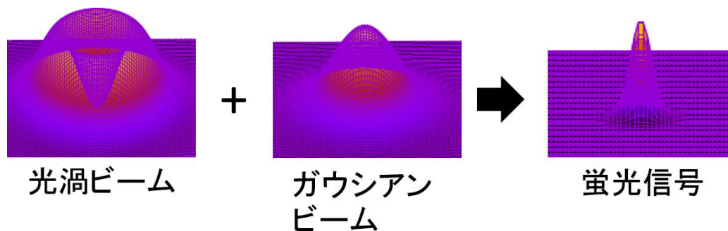
図 6-1 光渦を用いた分解能を小さくする仕組み
