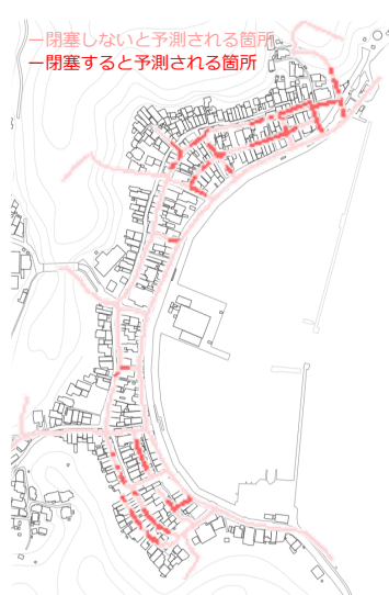
図 5.2 道路閉塞予測箇所
