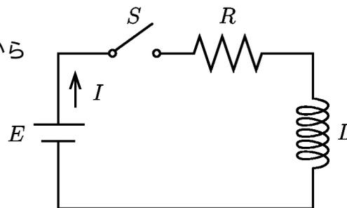
をみます。ここで  $L$  は自己インダクタンス、 $R$  は抵抗、 $E$  は起電力と呼ばれる正の定数である。今  $t$  秒後の電気量 (電荷) を  $q = q(t)$  とおくと電流  $I$  は  $I = \frac{dq}{dt}$  となる。つまり電流は電荷  $q$  の流れる速度である。上の微分方程式を  $I = \frac{dq}{dt}$  として  $q$  の式になおすと
