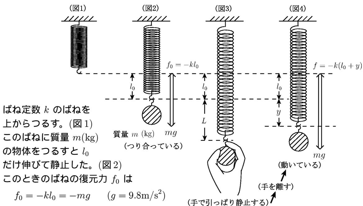
ばね定数  $k$  のばねを上からつるす。(図1) このばねに質量  $m$ (kg) の物体をつるすと  $l_0$
