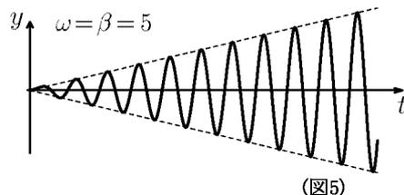
(注) 問 2 の解のグラフは図 5 の実線である。図 5 の点線は直線  $y = \pm \frac{t}{2}$  である。つまり時刻  $t$  における振幅が  $\frac{t}{2}$  であり、時間とともに振幅が大きくなる。この現象を共振または共鳴という。
